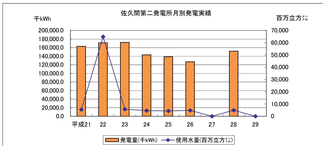
注) 佐久間第二発電所は、佐久間発電所放水口より直接取水しているため、ダム放水量は無い。
