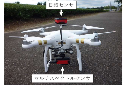
写真 ドローンに搭載した農業用マルチスペクトルカメラ。
