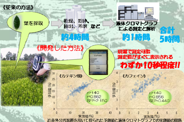
図1 可搬型近赤外分光装置を用いた新しい測定法と従来法との比較
