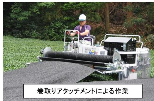
図1 乗用型摘採機に取り付ける直掛け被覆装置
