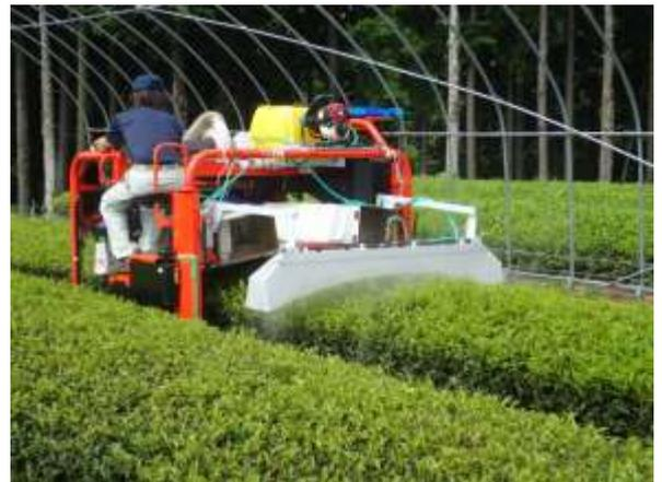
写真 乗用型摘採機搭載型薬剤散布装置
