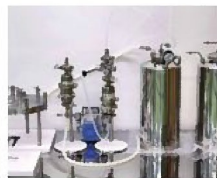
3. ろ過装置 (加圧濾過装置)
