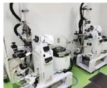
4. 濃縮装置 (エバポレーター)
