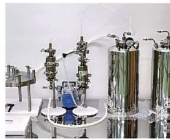
3. ろ過装置 (加圧濾過装置)
