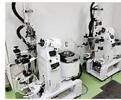
4. 濃縮装置 (エバポレーター)
