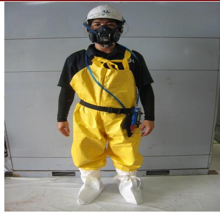
ズボンと冷気変換器を装着(上着着用前)
