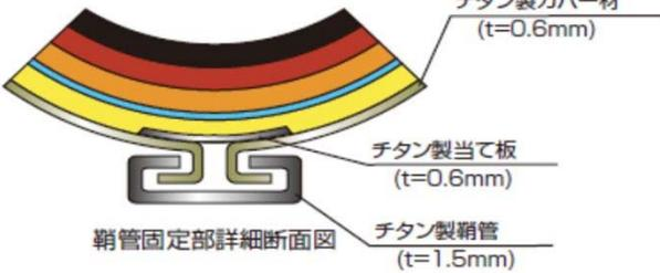
TP工法(鋼管杭)固定部分断面図
