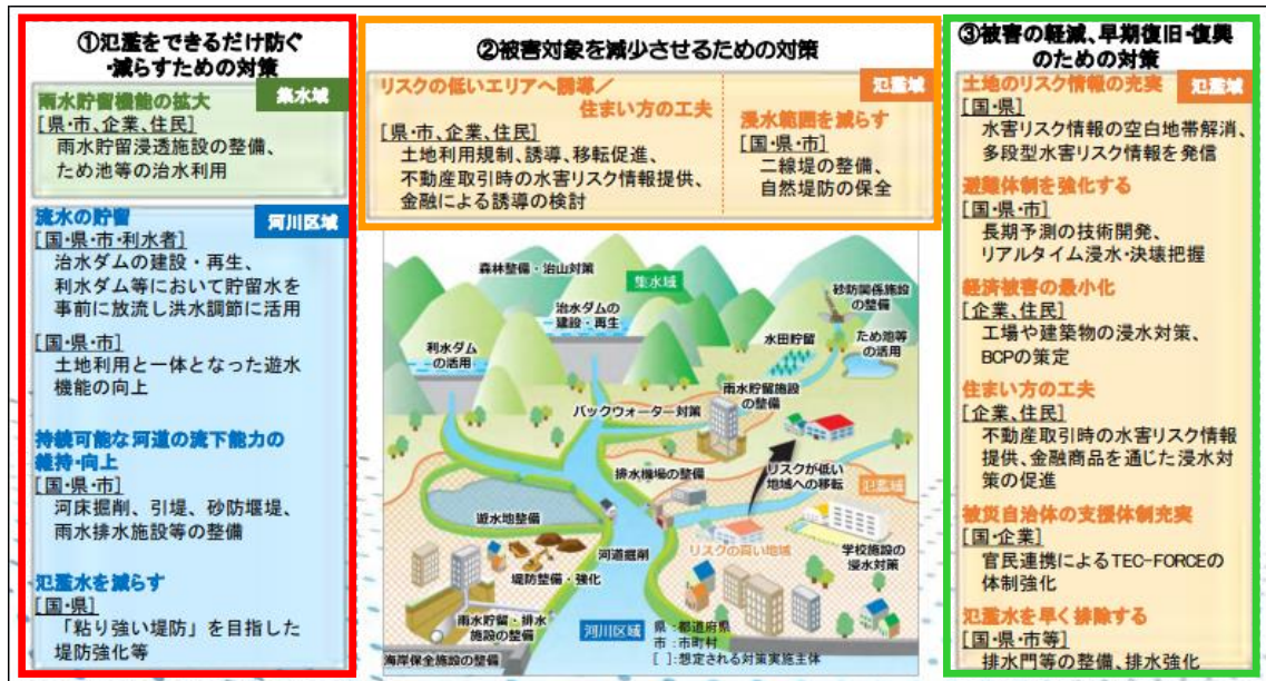
図 5-5 流域治水の「3つの方向性」の概念図
