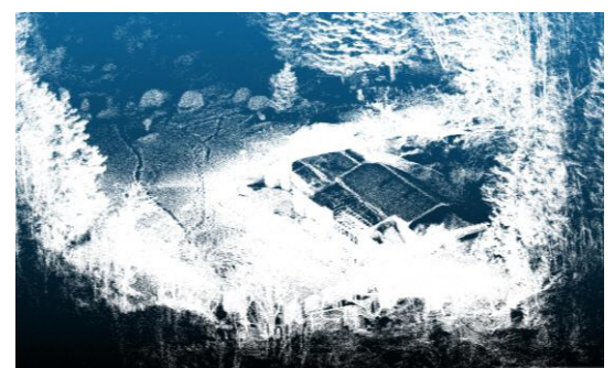
図 3 LiDAR スキャナによる点群測量(南御室小屋)
