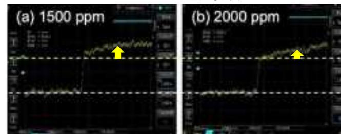
1500 ppm以上の濃度でクロロフィル蛍光強度が減少傾向
