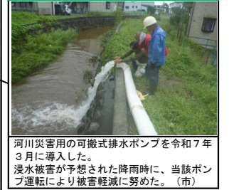
③-14 緊急排水用ポンプの運用 河川災害用の可搬式排水ポンプを令和7年3月に導入した。浸水被害が予想された降雨時に、当該ポンプ運転により被害軽減に努めた。(市)
