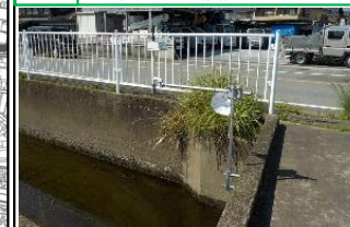
過去に浸水被害が発生した千代田町の市管理河川に水位計を設置し（2か所、右図の▽）、水位情報を公開している。（市）
