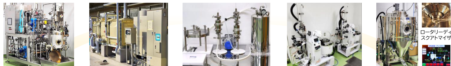
① 高温高圧多機能抽出装置 ② 冷却水製造装置 (アロマ水[芳香蒸留水]採取) ③ ろ過装置 (加圧濾過装置) ④ 濃縮装置 (エバポレーター) ⑤ 噴霧乾燥装置 (スプレードライヤー)
