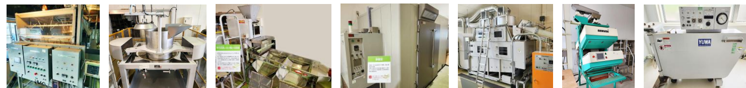
温風萎凋機 紅茶用大型揉捻機 平行式篩分機 静置(発酵)室 紅茶用大型(流動層)乾燥機 色彩選別機 大型窒素充填機 生葉重量が乾燥前の60~65%となるまで温風萎凋します。16~18時間 茶葉を強く「よる」ことで細胞を壊し、発酵を促します。45~90分 茶葉の塊をほどこき、大きさを篩い分けします。15~30分 温度25~30℃ 湿度90%RH以上で発酵させます。90~120分 温度100℃以上で発酵・本乾燥します。20~25分 茶葉と木茎等を分離します。15~30分 密閉容器に入れ窒素を充填します。10~20分
