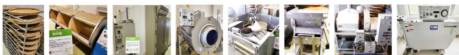
かはい 攪拌機 静置(発酵)室 台湾式殺青機 揉捻機 回転式玉解機 水乾機 大型窒素充填機 屋外での日干萎凋が基本ですが、曇天時は人工萎凋機で35℃60分間萎凋させます。 内部に突起を持つ装置で攪拌(揺青)します。20分 温度15℃ 湿度75%で半発酵させます。12時間 温度200~250℃で酸化酵素を失活(殺青)させます。時間10~20分 茶葉の水分を均一にします。10~20分 茶葉の塊をほどこします。10~15分 第一 90℃ 60分 第二 100℃ 30分 密閉容器に入れ窒素を充填します。10~20分
