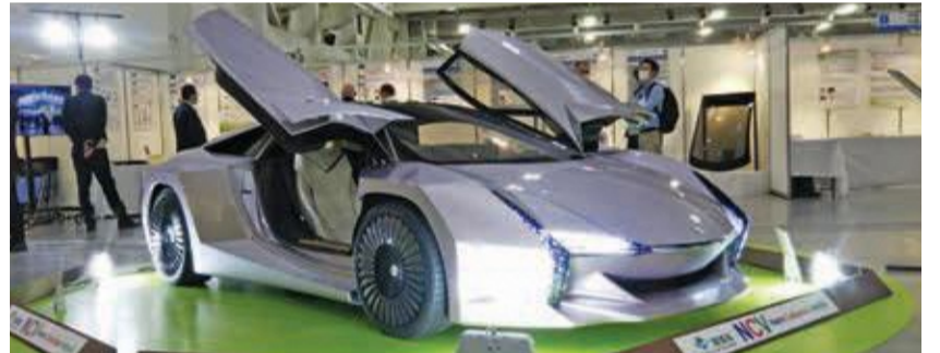
車体にCNFを使用したNCV(ナノ・セルロース・ビーフル) (令和4年11月8日ふじのくにCNF総合展示会)
