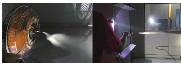
▲軸流ファンと Aero Optim の流れの比較
