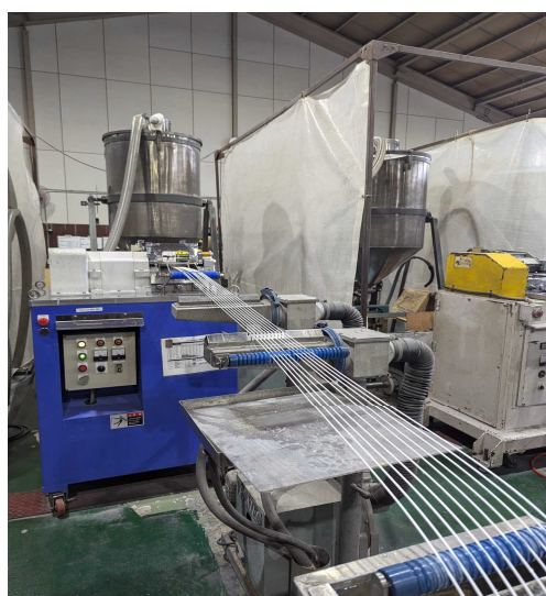
▲途中で切れないよう 絶妙な太さで抽出された原料が流れている
