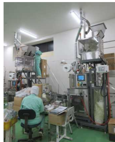
▲原料を計量、充填する装置
