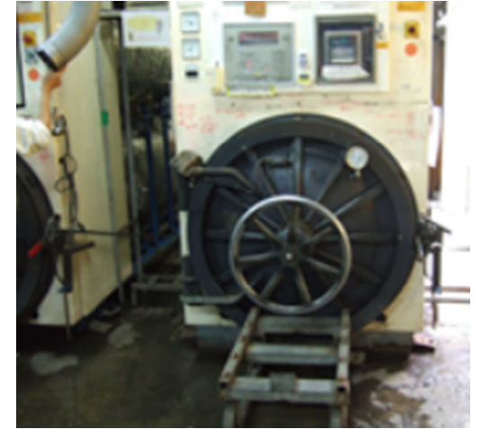
▲熱水式回転レトルト 製品内容物へのダメージ少なく殺菌できる
