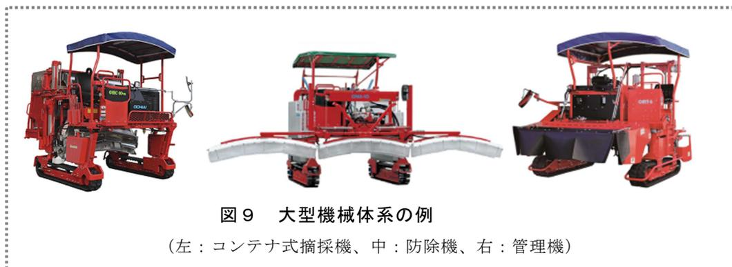
コンテナ式乗用型摘採機、乗用型防除機、乗用型管理機を基本とする「大型機械体系」を導入し、摘採・整せん枝、防除、施肥・耕起、裾刈り等の作業(準備・移動及びその他を含む)を行った場合、茶園管理に要する年間作業時間は約39時間/10aとなり、可搬型摘採機や自走式施肥機等を利用した作業体系(約108時間/10a)の36%程度に低減できると試算されました(表2)。
