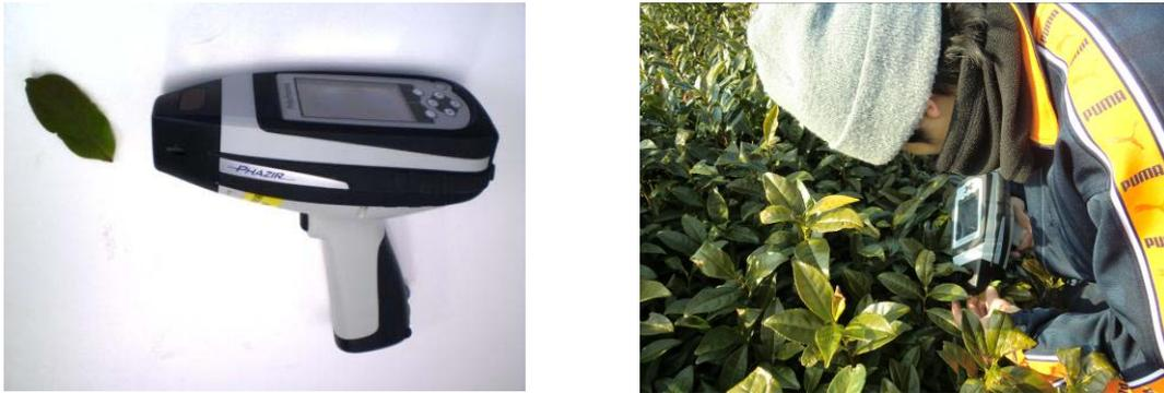
図1 可搬型近赤外分光装置(左:装置本体 右:測定の様子)
