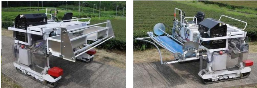
図 1 開発された直掛け被覆機械（左：展開アタッチメント、右：巻取りアタッチメント）
