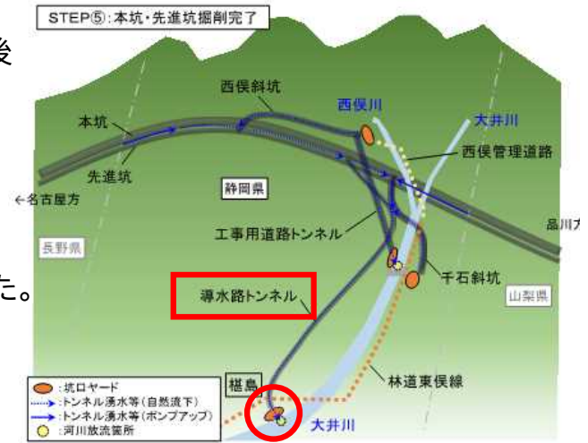
図 1.29 トンネル湧水等の流れ、河川への放流箇所 (STEP5)
