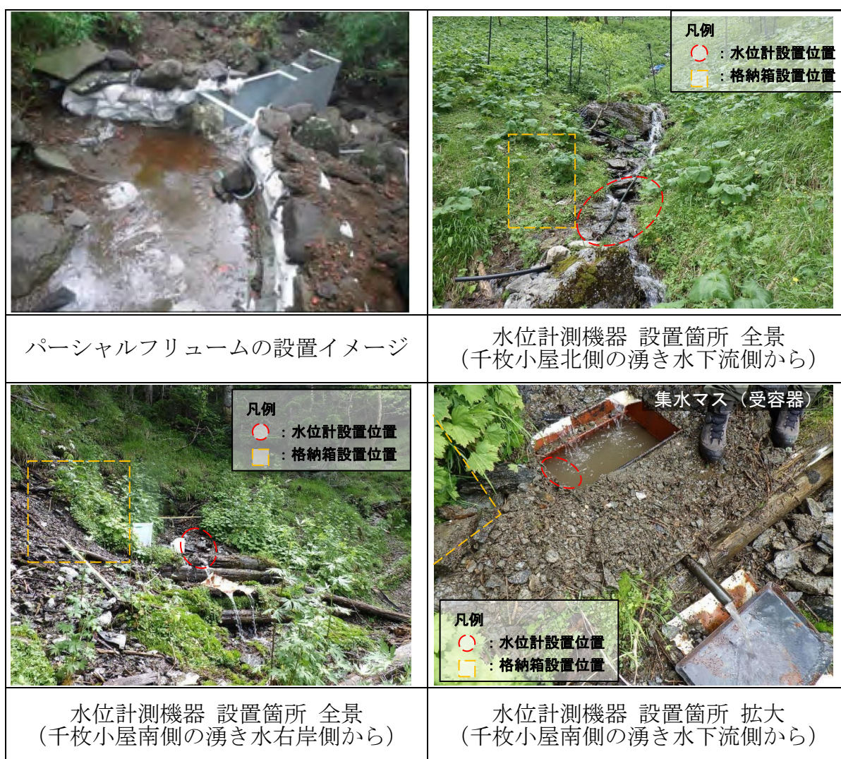
図 1 1 地表面付近の湧き水モニタリングの例
