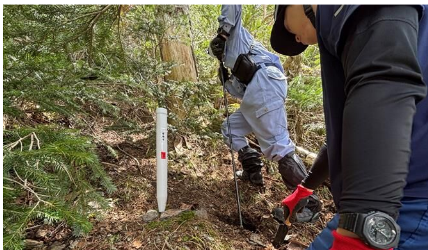
図 18 ハンドオーガーによる掘削状況
