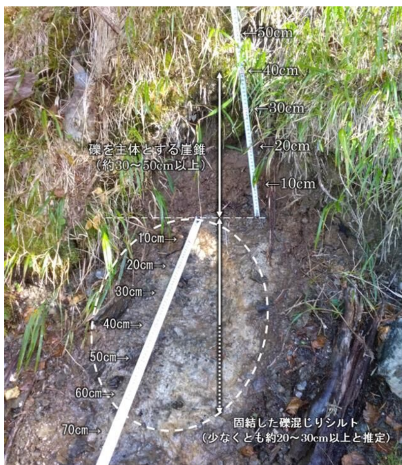
図 20 湧き水箇所のごく近傍での掘削調査の結果（再掲）
