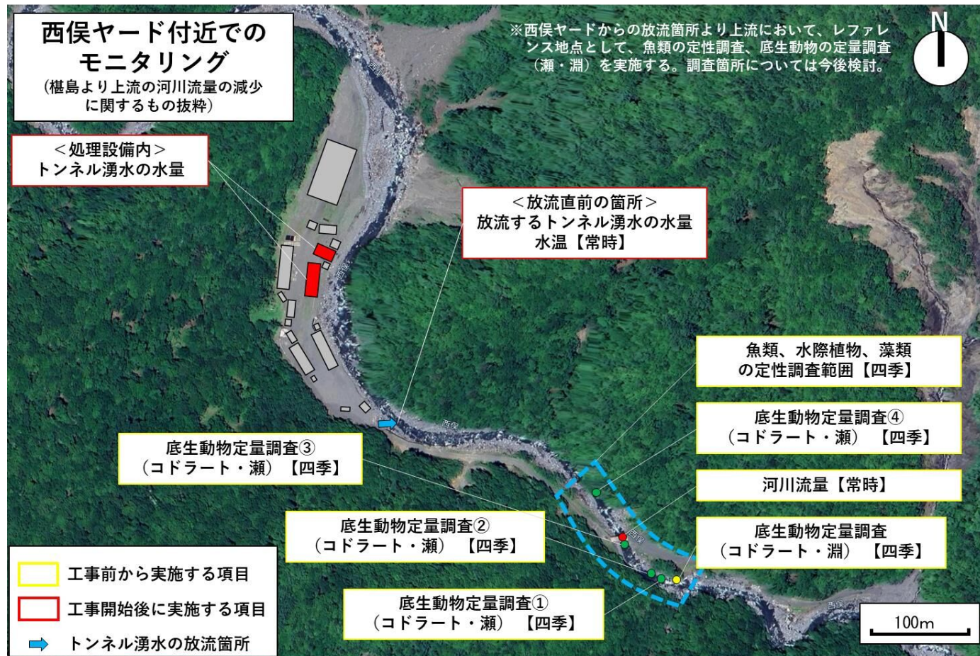
図 4 西俣ヤード周辺における河川流量の変化に係るモニタリング計画
