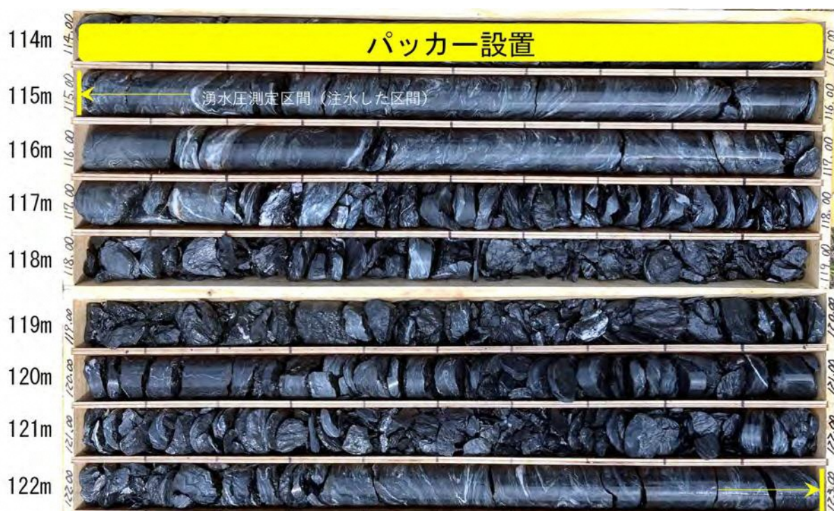
写真 5 孔内湧水圧測定 No. 3 (115.0m～123.0m) コア写真
