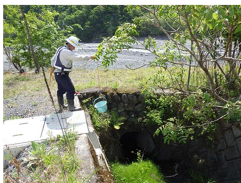
写真 7 放流する水の水質の確認
