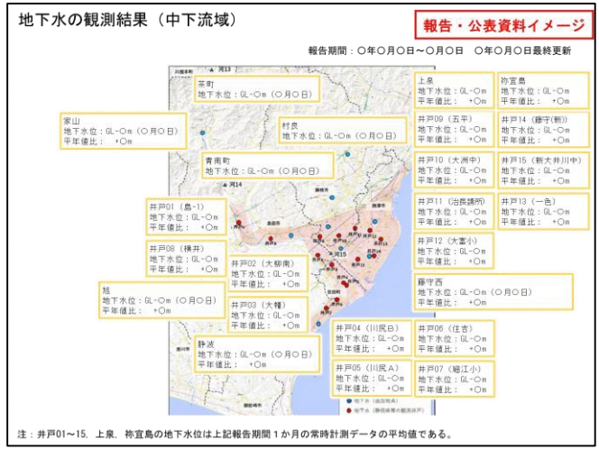
図9 工事中のモニタリング結果の報告・公表資料(イメージ)
