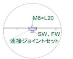
接続ジョイント取り付け詳細図 (S=2:1)
