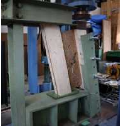
図 1 面内せん断試験のセットアップ
