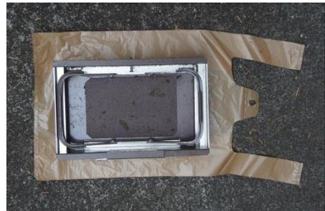
また、設置時の作業性を高めるため、ビニールを上皿に押し当てる板（ガイド内側に納まるサイズに加工したもの）を準備するとよい。
