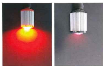
図2 供試光源の点灯中の様子 左：赤色LED (DPDL-R-9W) 右：遠赤色LED (DPDL-FR-9W (現在販売中止)) (上下ともに鍋清株式会社製)
