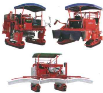
図4 大型機械体系の例 (左上:コンテナ式摘採機、 右上:管理機、下:防除機) ※落合刃物工業(株)HPから引用
