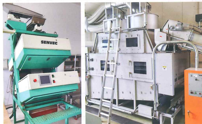
図3 発酵茶(紅茶)製造設備 (一部) 色彩選別機(左) 紅茶用乾燥機(右)
