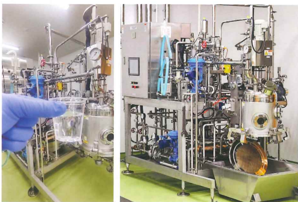
図4 高温高圧多機能抽出装置(右) 緑茶アロマ蒸留水(左)
