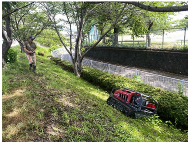
リモコン式草刈機による堤防除草状況
