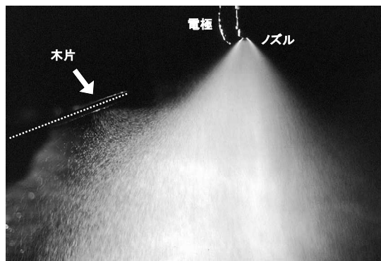
図1-4 帯電液滴が木片の裏側(下面)へ回り込んで吸着する様子
