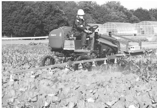
図 3-8 露地キャベツ防除実証試験の供試機外観
