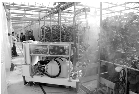
図 4-9 メロン防除ロボットの作業状況（左：旋回中，右：畝間作業中）
