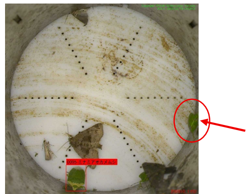
図6 チャバネアオカメムシ自動計測におけるエラー事例 (頭部側から撮影された個体を認識できていない(矢印))
