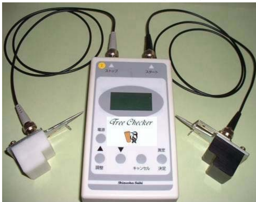
▲ 開発した立木強度測定器「Tree Checker」
