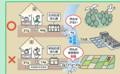
合併処理浄化槽のはたらき
