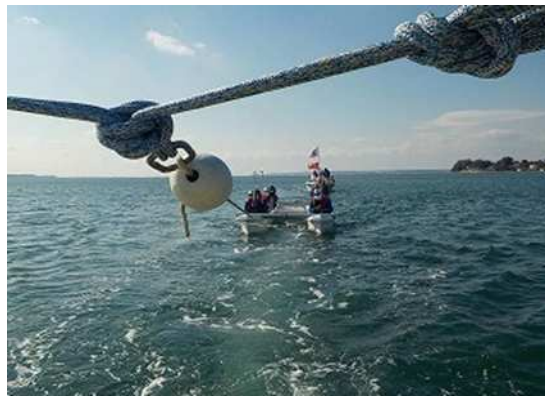
ダブルハルカヌー側 常設専用Y字ロープ
