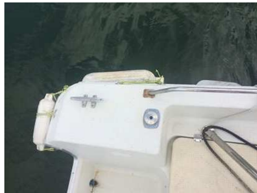
23F艇側 浮き付き取り付けロープおよび常設クリート
