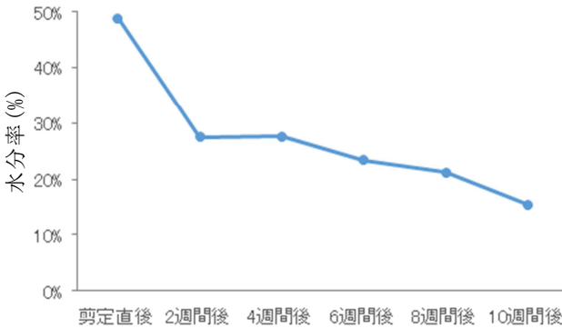
図1 野積で自然乾燥した剪定枝の水分率の推移 (剪定日:2024年3月12日)
