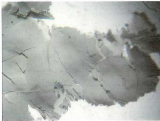
写真-11 2階ホール内部壁 吹付タイル 顕微鏡視野：10倍
