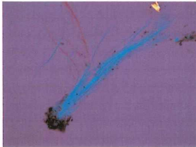
写真・5 2階湯沸室天井 石綿ケイ酸カルシウム板 顕微鏡視野：100倍
