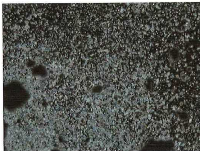
写真・12 外壁 吹付タイル 顕微鏡視野：100 倍
