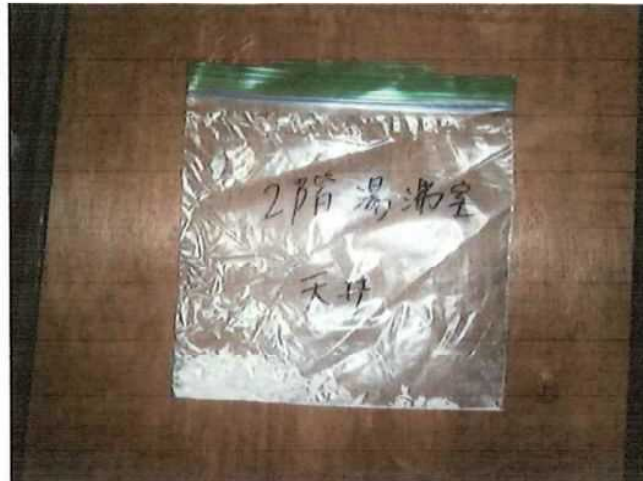
写真・4 2階湯沸室天井 石綿ケイ酸カルシウム板 採取試料
