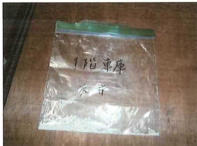
写真-3 1階車庫天井 石綿ケイ酸カルシウム板 採取試料
