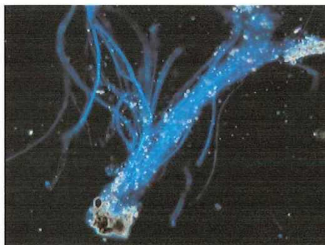
写真・6 2階湯沸室天井 石綿ケイ酸カルシウム板 nD=1.550(クリソタイル) 顕微鏡視野：100倍
