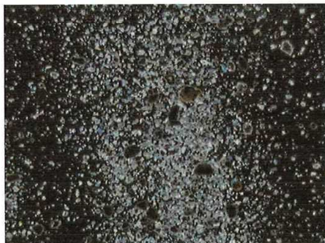
写真-12 1 階ホール内部壁 吹付タイル 顕微鏡視野：100 倍
