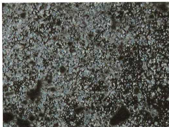
写真・12 階段内部壁 吹付タイル 顕微鏡視野：100 倍
