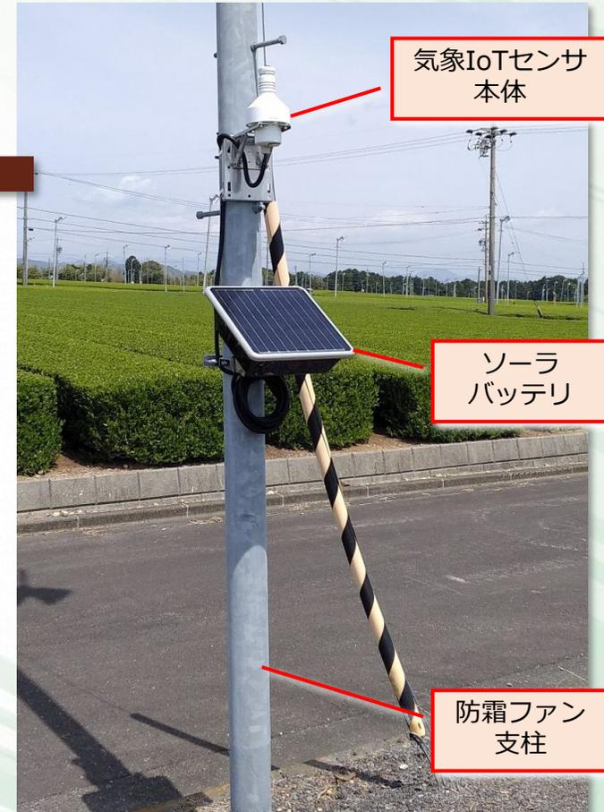
実証圃場（島田市湯日）に気象IoTセンサを設置しクラウドサービスから観測値を取得
