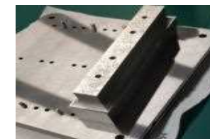
金属3Dプリンタで 製造した高放熱金型
