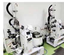
④ 濃縮装置 (エバポレーター)
