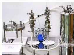
③ ろ過装置 (加圧濾過装置)
