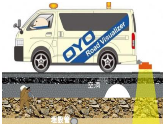
路面下空洞探査の模式図
