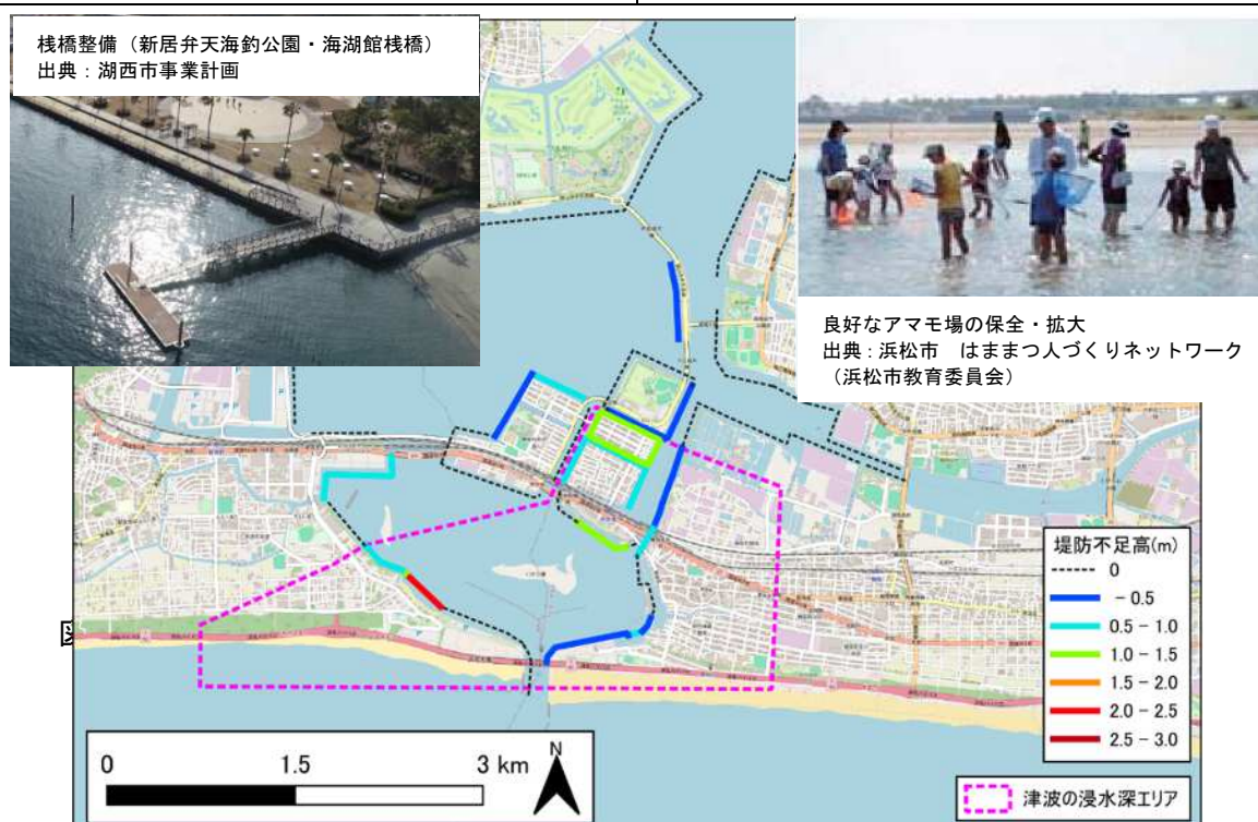
図 6.3 湖岸の防護目標に対する堤防の不足高（舞阪・弁天島・雄踏・新居エリア）
