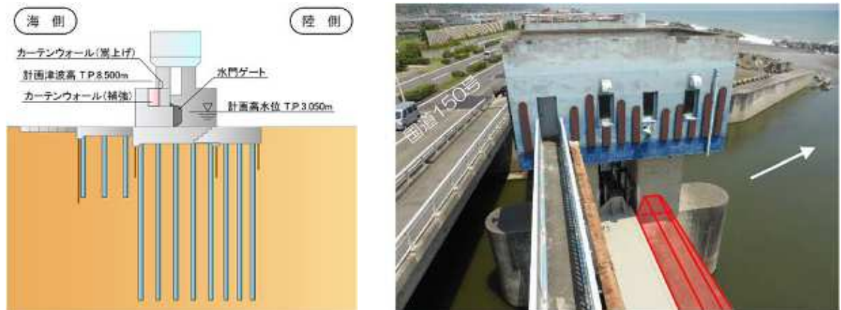
図 4-19 津波対策水門イメージ図
