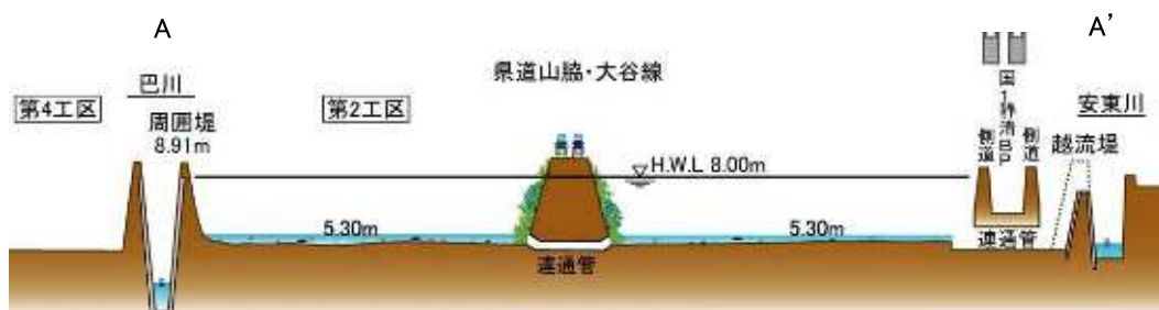
図 4-5 麻機遊水地第2工区横断イメージ図
