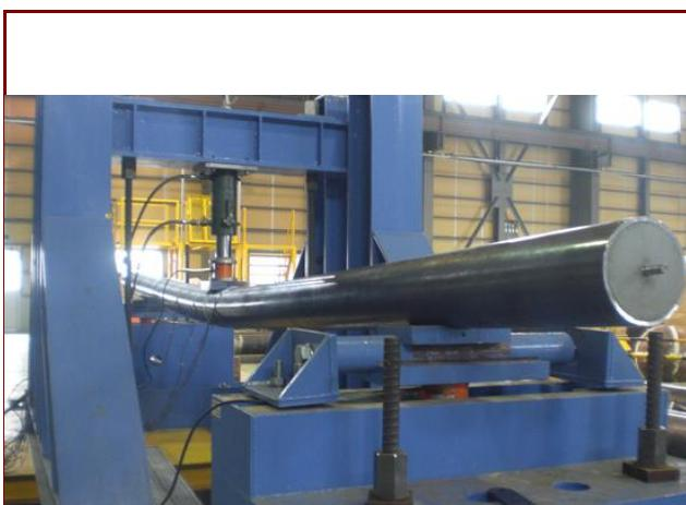
実物支柱供試体への静的載荷実験
